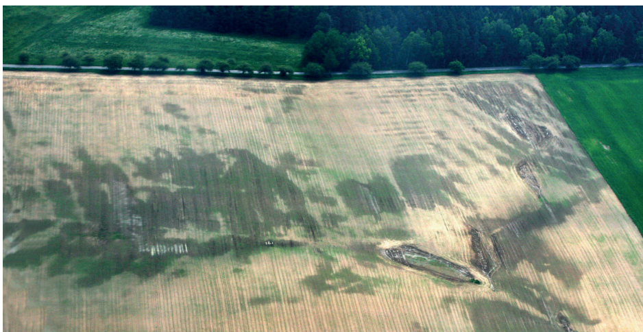
Obr 3 – ukázka projevu poruch a omezené funkčnosti drenážního systému na ploše orné půdy s nezapojeným porostem (termín snímkování 26. 5. 2008)
