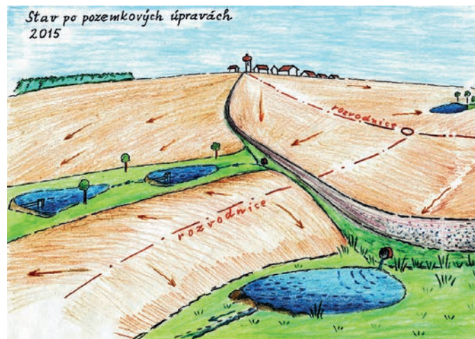
Sběrný průřeh se zasakovacím pásem a dřevinami (Hromnice, 2010–2015)
