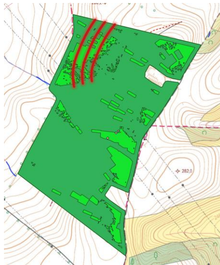
Obrázek 10: Vyhodnocení podélného sklonu trajektorií a DPB. Zelená barva prozrazuje, že podmínky jako podélný sklon a DSO ležící uvnitř stabilizačních ploch byly splněny, nicméně červené linie označují trajektorie, které neleží v osách pásů
